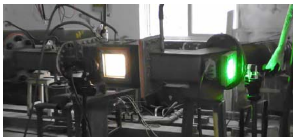
图3 PIV 燃烧流场测量
